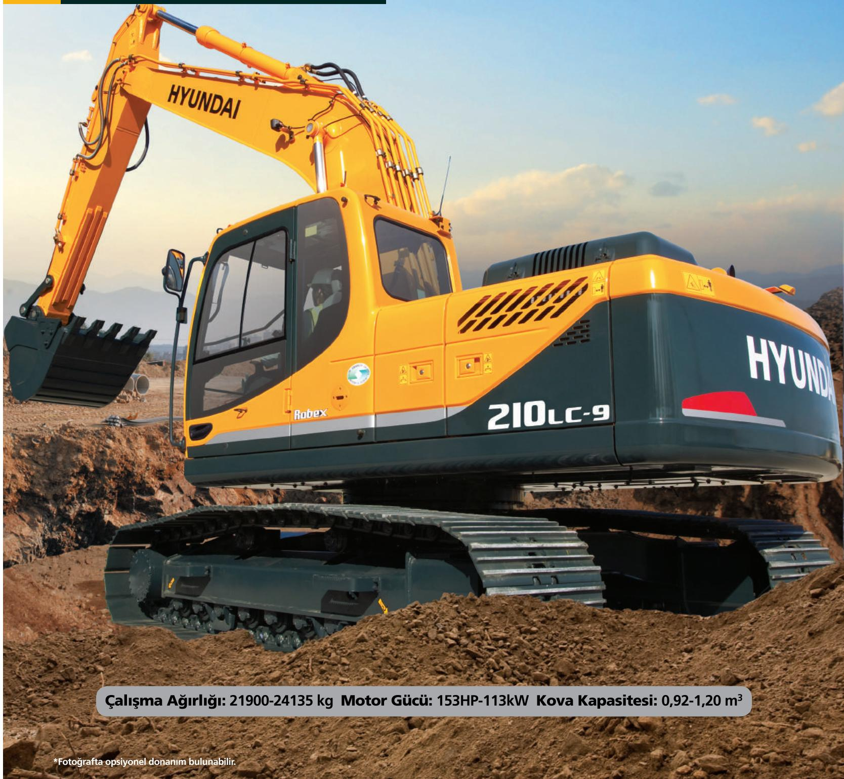
**Çalışma Ağırlığı: 21900-24135 kg Motor Gücü: 153HP-113kW Kova Kapasitesi: 0,92-1,20 m<sup>3</sup>**
