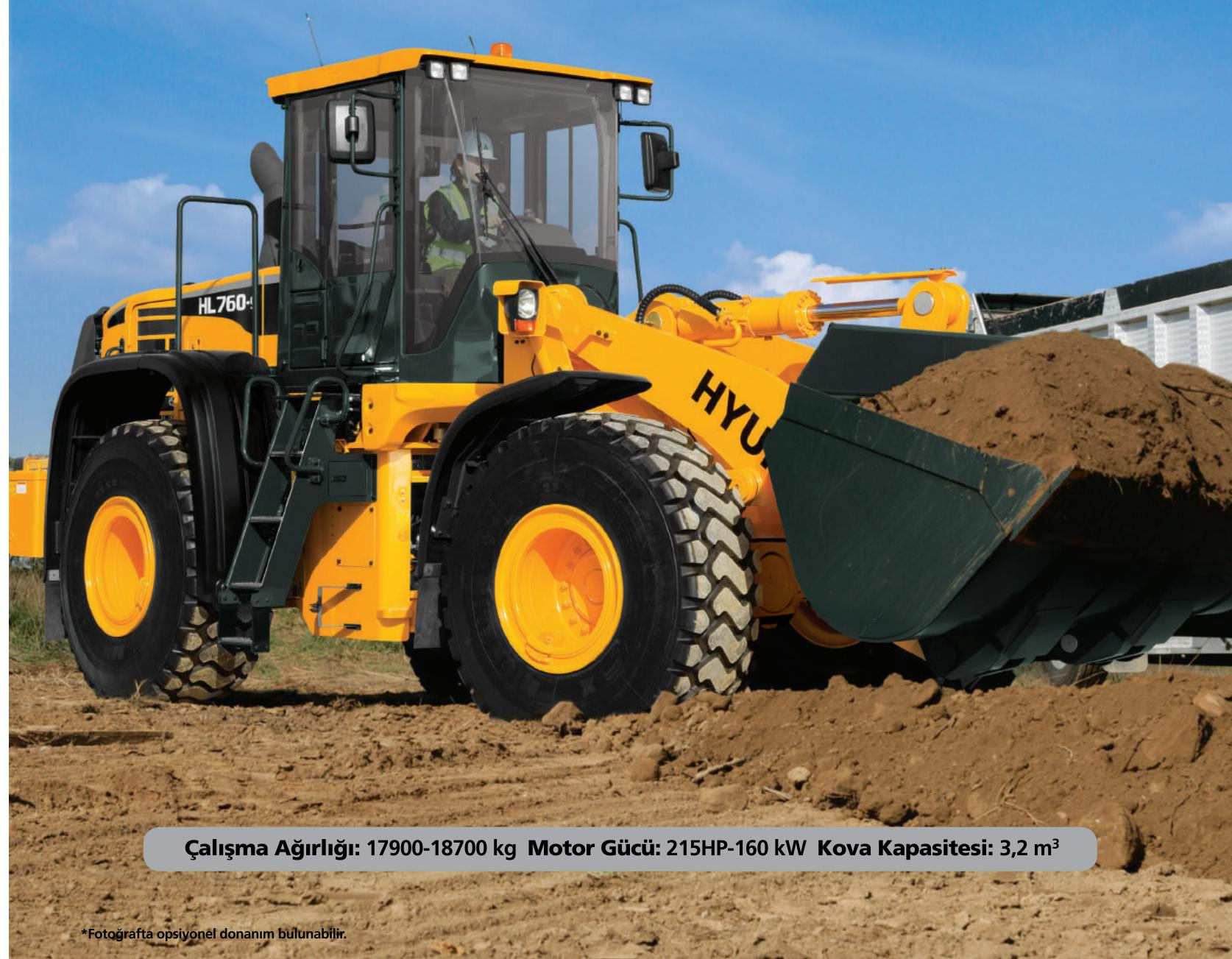
**Çalışma Ağırlığı: 17900-18700 kg Motor Gücü: 215HP-160 kW Kova Kapasitesi: 3,2 m<sup>3</sup>**
