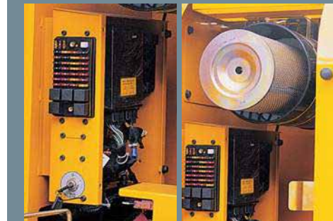
Merkezi Elektrik Kontrol Kutusu ve Kolay Değişir Hava Filtresi
